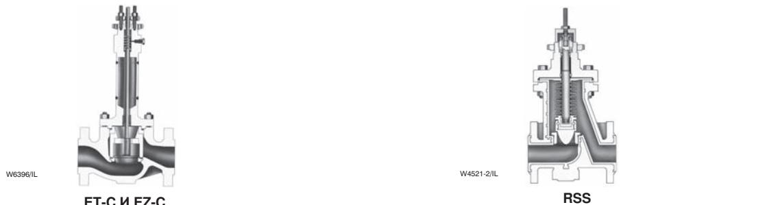
Рис. 8. Криогенные клапаны и клапаны с внутренним покрытием
