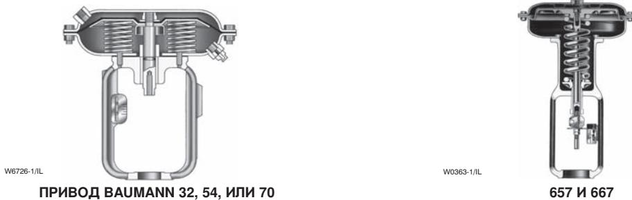
Рис. 11. Приводы для клапанов с поступательным движением штока
