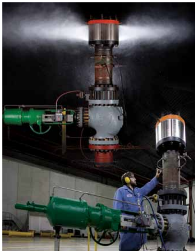
Испытание на шум вентиляционного диффузора NPS 12.
