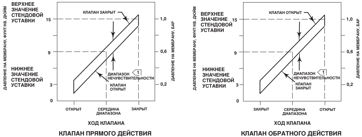
Рисунок 5. Типовая реакция клапана на зону нечувствительности
