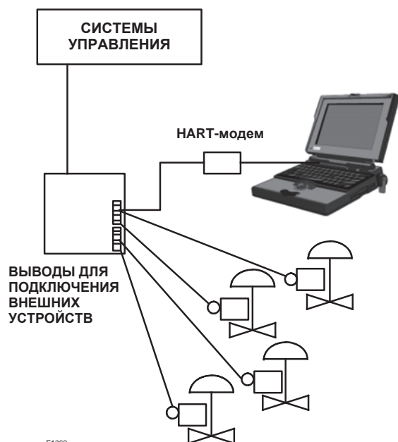
Рис. А-2. Стандартная организация связи прибора FIELDVUE с персональным компьютером через программу ValveLink
