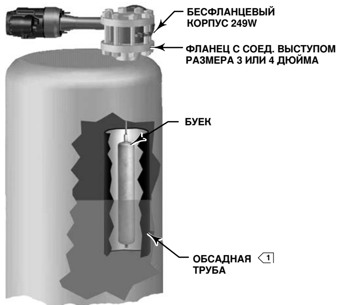
Рисунок 4. Уровнемер 249W, установленный сверху резервуара
